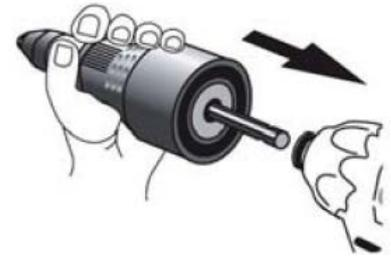
2. Démarrez la machine prudemment avec une rotation à gauche, tout en retenant le mandrin à river avec la main. Retenez le support tout en laissant tourner la machine à un bas régime jusqu'à ce qu'un encliquetage soit audible.
